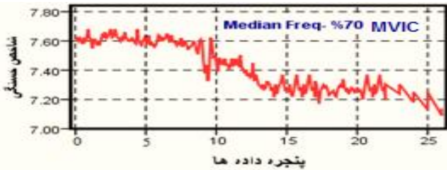
شکل ۱. اندازه‌های عینی پارامتر میانه عضله ذوزنقه در طی پروتکل‌های خستگی ارادی
